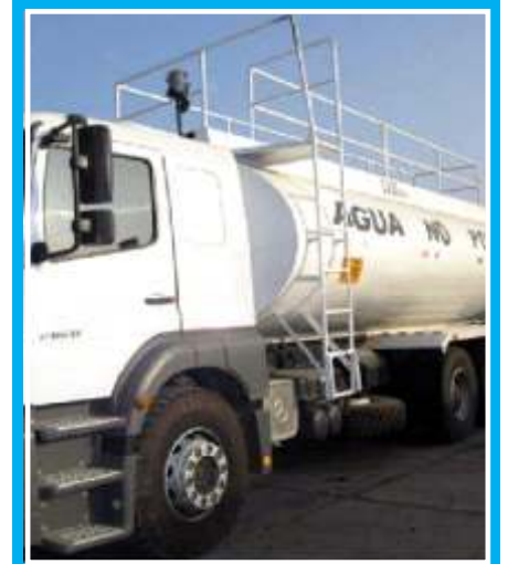
Montaje de plataforma en chasis
