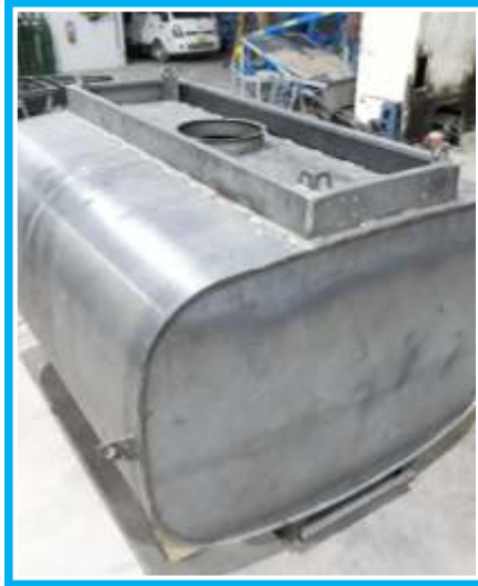
Tanque de combustible
