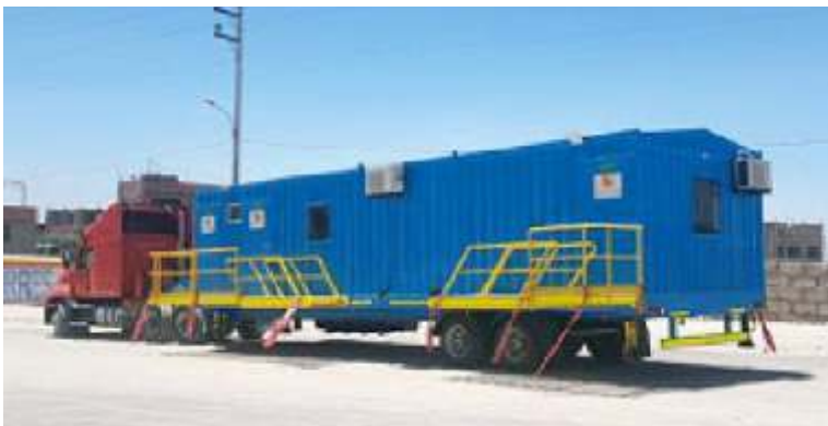
Diseño y fabricación de remolques para áreas de descanso del personal de operaciones mina.
